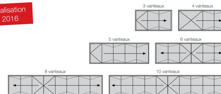
La porte repliable en aluminium WICSLIDE FD 75 est la solution idéale pour assurer la modularité des espaces ou pour assurer le maximum de largeur de passage en position ouverte en limitant au maximum l'espace requis pour le rangement des vantaux.
