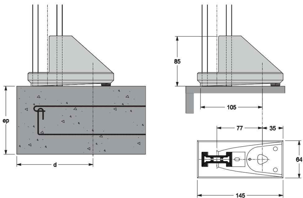
Platine une seule fixation - Echelle 1/2
