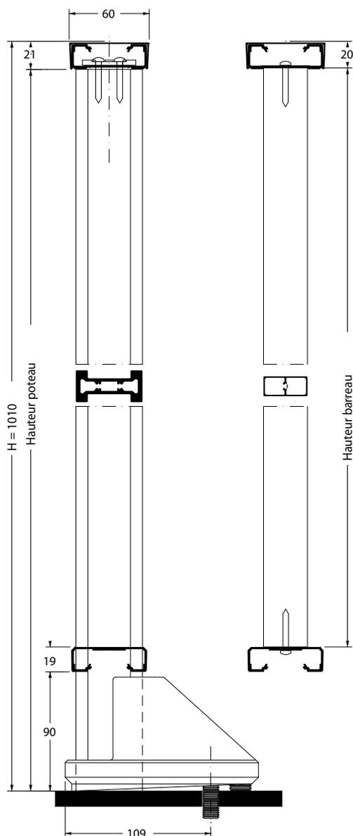
Coupe verticale barreaudage sous main courante - Echelle 1/4 - Réf. : WLBCV1 et WLBCV2
